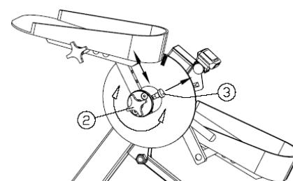
3. **Justerung av pedalerna:** → Längden på pedalerna kan justeras genom att först lossa ratten (2). Därefter dras låstappen (3) ut samtidigt som pedalen skjuts ut/in till önskat läge. Se till, att låstappen (3) går i ett hål och låser igen. Skruva därefter åt ratten (2).
